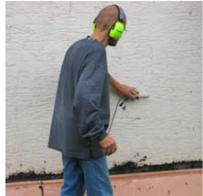
Abb. 7: Messung des Außenschalldruckpegels
