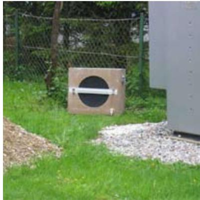
Abb. 6: Referenzlautsprecher als Schallquelle im Versuchsaufbau
